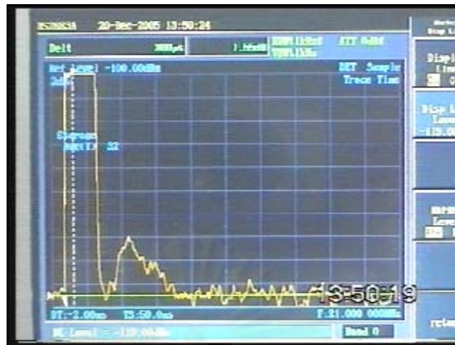
รูปที่ 4.25 ตัวอย่างผลการตรวจวัดสัญญาณที่กระเจิงจากพายุ วันที่ 20/12/48 เวลา 13:50:19 โดยสัญญาณส่งมีความกว้างพัลส์ 5 mSec
