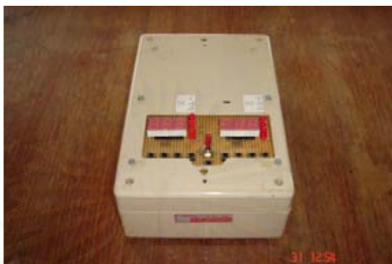
รูปที่ ง.2 เครื่องกำเนิดและควบคุมสัญญาณมอดูเลต
