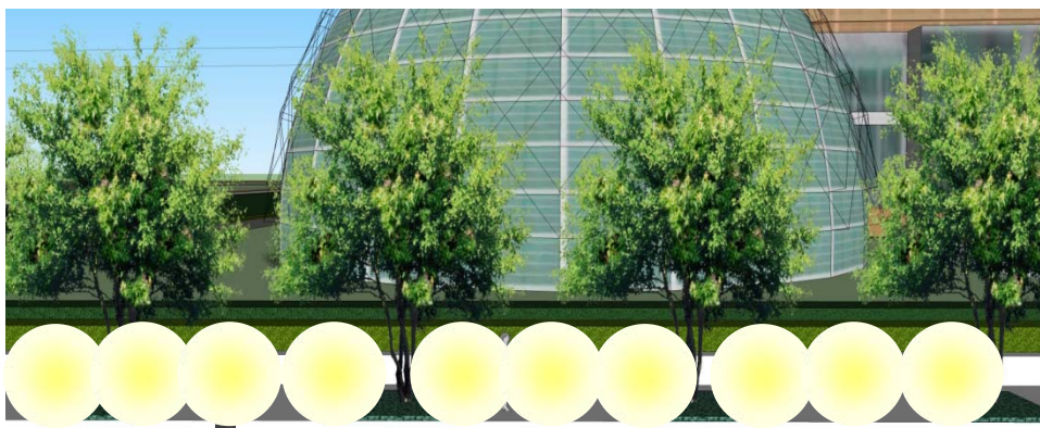
ภาพ 7.13 การเลือกใช้ดวงโคมประเภทไฟเสาเดี่ยวติดตั้งในพื้นที่ เพื่อให้ความสว่างในระดับล่าง สำหรับส่องทางเพื่อคนสัญจรในพื้นที่ทางเท้าสาธารณะช่วงเวลากลางคืน
