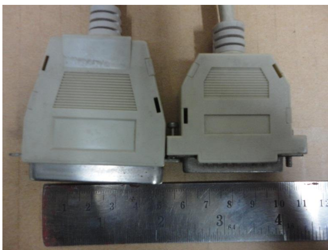
รูปที่ 3.11 Connector RS232 25-pin
