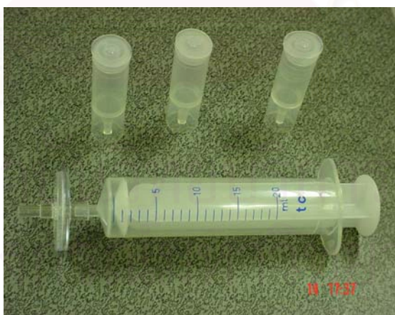
รูปที่ 3.9 อุปกรณ์ที่ใช้ในการกรองตัวอย่างพร้อม vial
