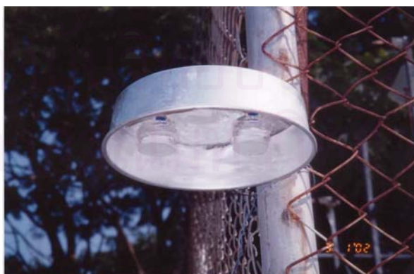
รูปที่ 3.6 การติดตั้ง passive sampler พร้อม protective shield ในพื้นที่ศึกษา
