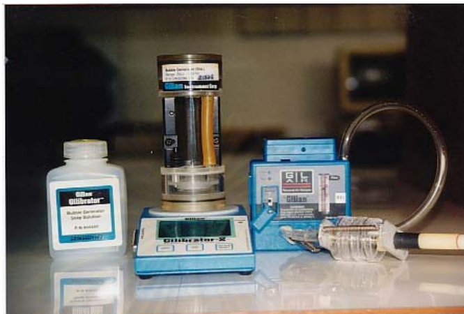
รูปที่ 3.14 อุปกรณ์เก็บตัวอย่างฝุ่นละอองเล็กกว่า 10 ไมครอน และชุดปรับเทียบ
