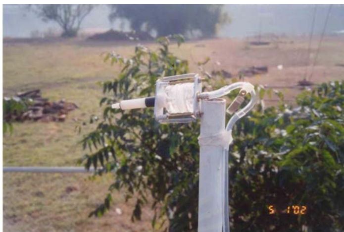
รูปที่ 3.16 การเก็บตัวอย่างฝุ่นละอองเล็กกว่า 10 ไมครอน
