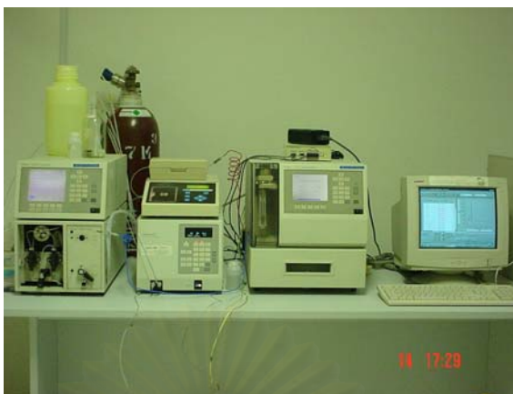
รูปที่ 3.10 เครื่องมือ ion chromatography สำหรับวิเคราะห์ปริมาณซัลเฟต ( \text{SO}_4^{2-} )
