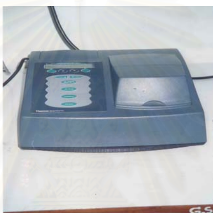
รูปที่ 3.13 เครื่อง spectrophotometer สำหรับวิเคราะห์ปริมาณไนไตรท์ ( \text{NO}_2^- )
