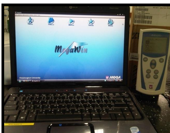
ภาพที่ 3.1 แสดงเครื่อง Electromyography เครื่องหมายการค้า Megawin 6000 พร้อมคอมพิวเตอร์บันทึกข้อมูล และ Software วิเคราะห์คลื่นสัญญาณ ไฟฟ้ากล้ามเนื้อ Megawin 6000 Version 3.0
