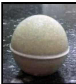
ภาพที่ 3.4.ง แสดง Reflective marker เส้นผ่านศูนย์กลางขนาด 2.5 เซนติเมตร
