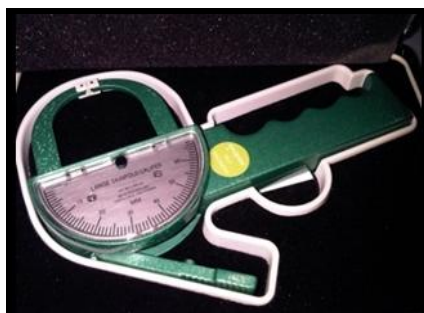
ภาพที่ 3.3 แสดงเครื่องวัดความหนาของชั้นไขมันใต้ผิวหนัง (Lange Bodyfat Skinfold Caliper C-130)
