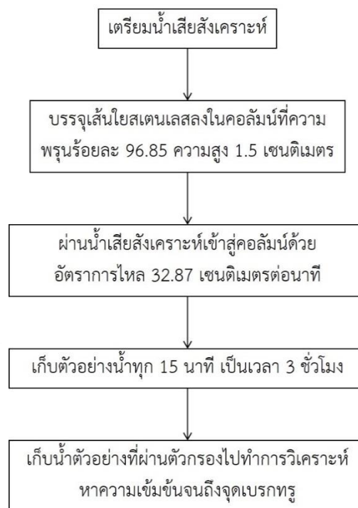
รูปที่ 3. 8 การศึกษาผลกระทบของสนามแม่เหล็กบนเส้นใยสแตนเลส ต่อประสิทธิภาพในการแยกตัวกลางดูดซับ
