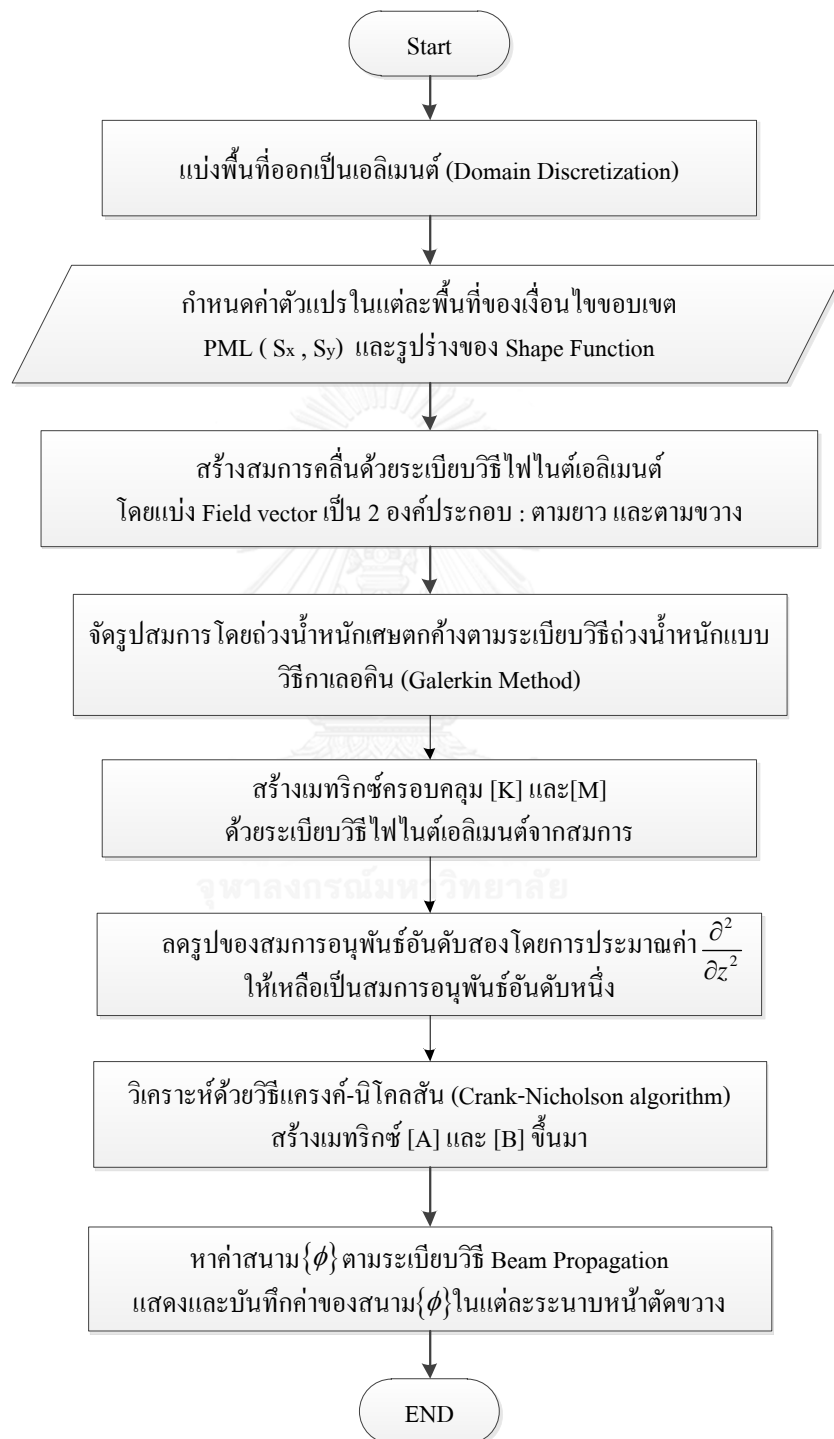
ภาพที่ 3.3 ขั้นตอนของระเบียบวิธีไฟไนต์เอลิเมนต์ปริมโพรพาเกชัน
