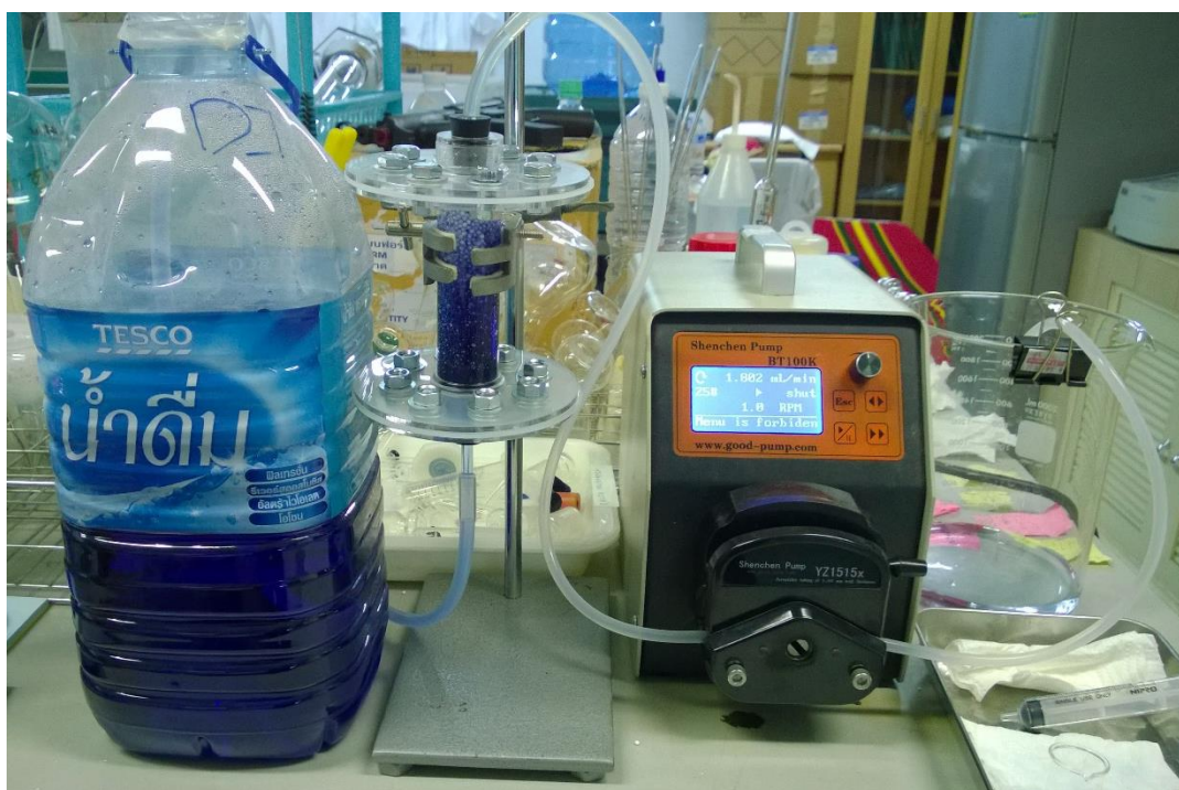
รูปที่ 3.2 การทดลองการดูดซับในระบบคอลัมน์
