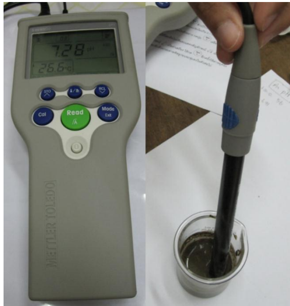
ภาพที่ 3.15 วิเคราะห์ความเป็นกรด-ด่าง ของดิน ด้วย pH meter
