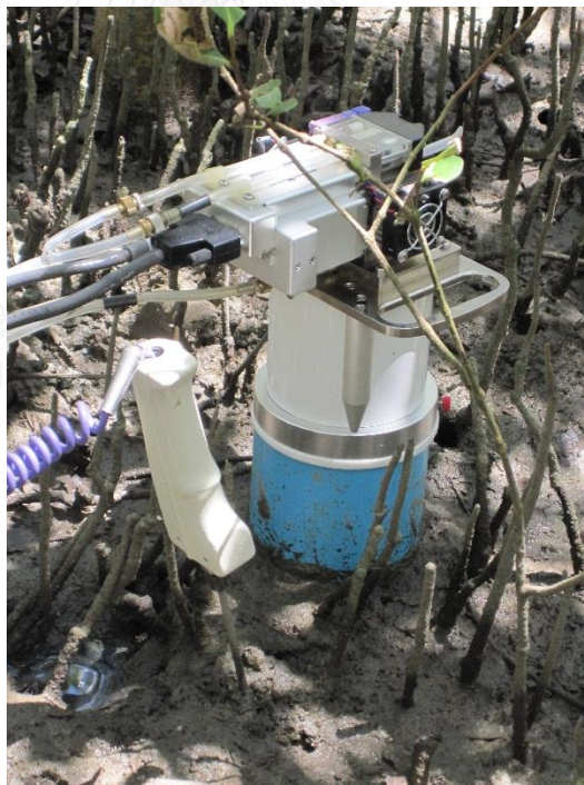
ภาพที่ 3.16 วัดอุณหภูมิดินโดยใช้ soil temperature probe (6000-09TC) ที่ต่อกับเครื่อง LI-6400
