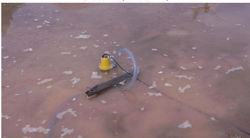
ภาพที่ 4.30 ทดสอบปั้มน้ำใส่แท็งค์ภายในบ้านลอยน้ำ
