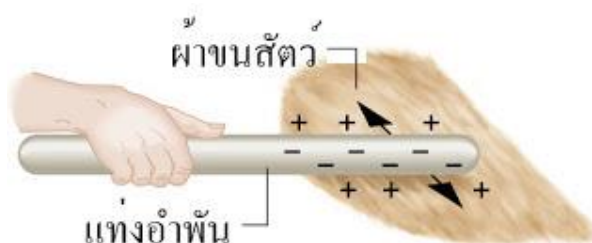
ภาพที่ 2.24 การเกิดไฟฟ้าสถิตจากการถูระหว่างแท่งอำพันและผ้าขนสัตว์ [25]
