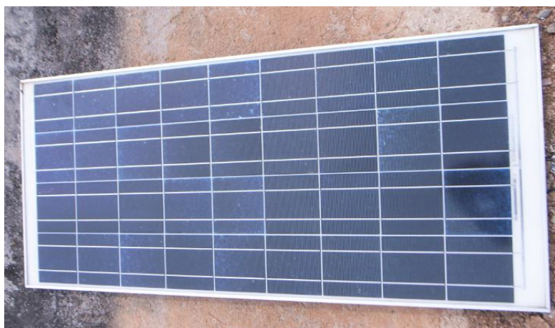
ภาพที่ 3.5 แผงเซลล์แสงอาทิตย์ ขนาด 250 วัตต์
