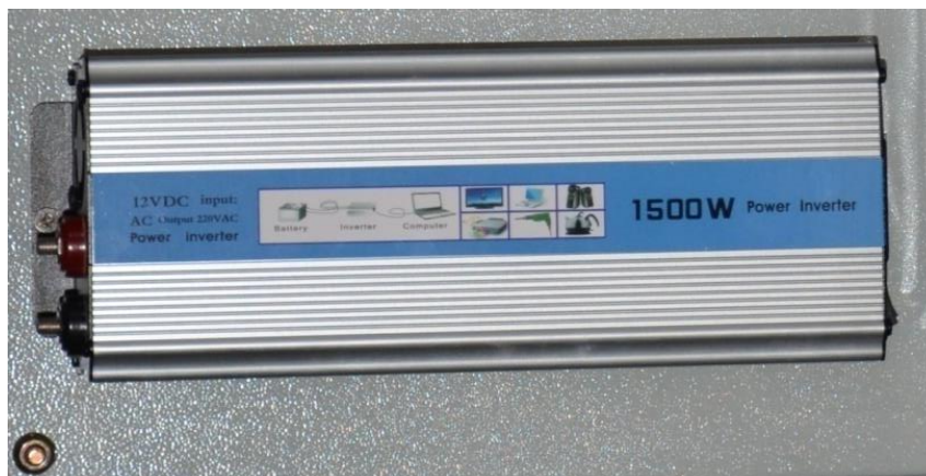
ภาพที่ 3.8 อินเวอร์เตอร์ขนาด 1,500 วัตต์
