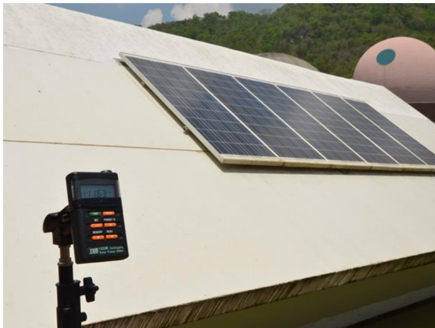
ภาพที่ 4.6 ภาพแสดงการเก็บข้อมูลค่าความเข้มแสงอาทิตย์ด้วยอุปกรณ์วัดค่าความเข้มแสงอาทิตย์
