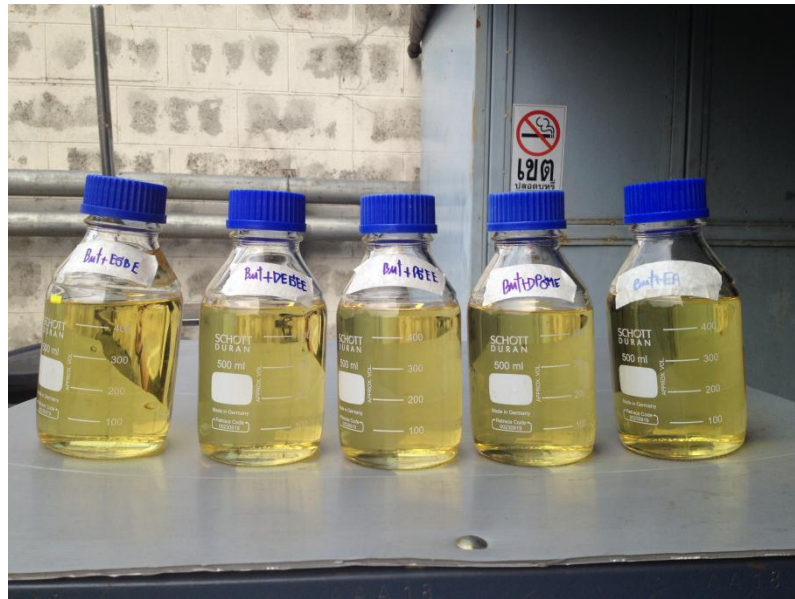
ภาพที่ ก-5 เซลล์เชื้อเพลิงชีวภาพที่รวมตัวเป็นเนื้อเดียวกันเพื่อนำไปทดสอบกับเครื่องยนต์ดีเซล
