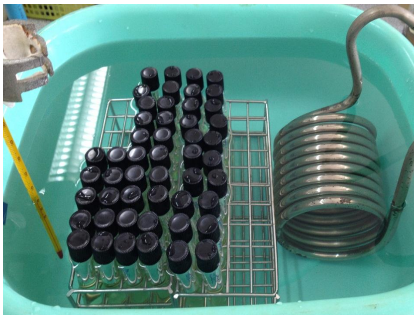
ภาพที่ ก-3 การติดตั้งอุปกรณ์การวัดจุดหลอมของเชื้อเพลิงชีวภาพไมโครอิมัลชัน
