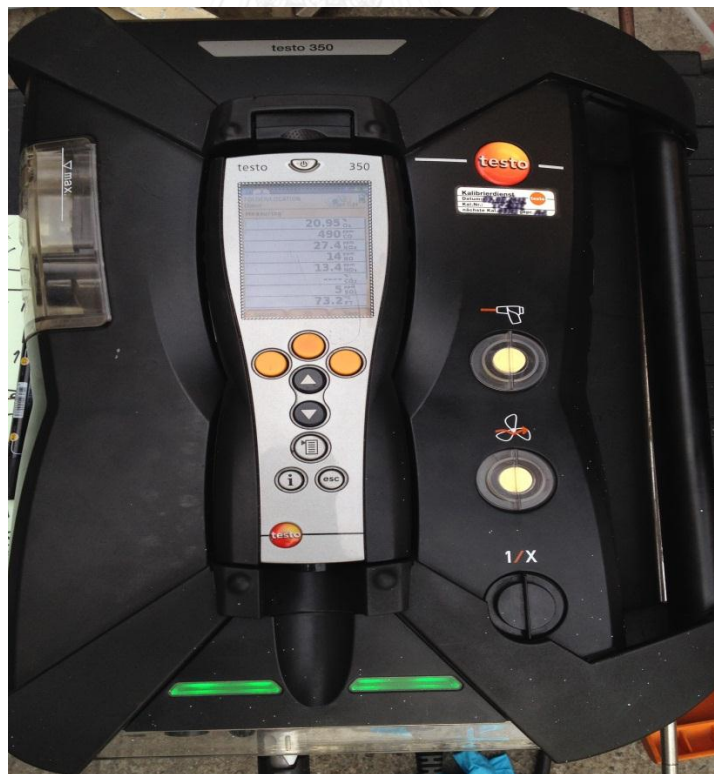
ภาพที่ ก-6 เครื่องวัดปริมาณก๊าซไอเสีย (Gas Analyzer Testo 350-XL)
