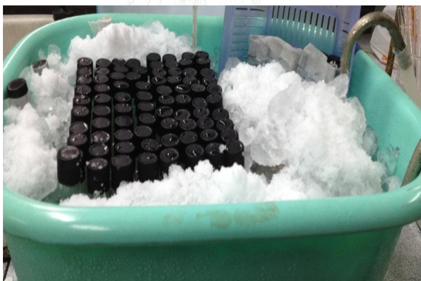
ภาพที่ ก-4 การติดตั้งอุปกรณ์การวัดจุดไหลเทของเชื้อเพลิงชีวภาพไมโครอิมัลชัน
