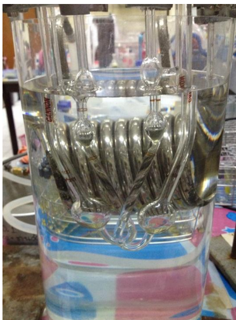
ภาพที่ ก-1 การติดตั้งอุปกรณ์การวัดความหนืด ที่อุณหภูมิ 15 และ 25 องศาเซลเซียส
