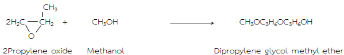
ภาพที่ 2-16 โครงสร้างทางเคมีของไดโพรพิลีนไกลคอลเมทิลอีเทอร์
