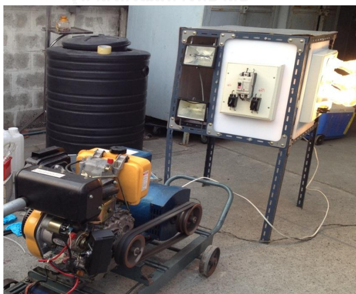
ภาพที่ 3-8 การติดตั้งอุปกรณ์การปล่อยก๊าซไอเสียของเชื้อเพลิงชีวภาพไมโครอิมัลชัน
