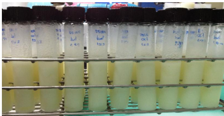
ภาพที่ 4-14 เชื้อเพลิงชีวภาพไมโครอิมัลชันที่ไม่สามารถไหลเทที่อุณหภูมิ -6 องศาเซลเซียส
