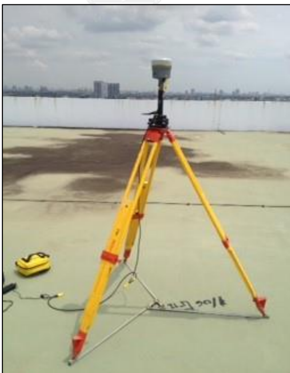
รูปที่ 2.17 การรังวัดแบบสถิต
