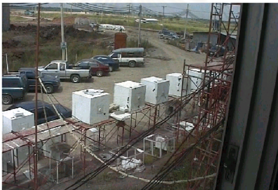
ภาพที่ 3.12 แสดงการตั้งเซลล์ทดสอบภายในสถานที่ทดลองซึ่งตั้งหันหน้าไปในทิศทางเดียวกันและอยู่ในระดับเดียวกันในสภาพแวดล้อมเดียวกันเพื่อสร้างสภาวะที่สามารถควบคุมตัวแปรควบคุมให้เหมือนกันได้ และทดสอบตั้งมาตรฐานเซลล์ทดสอบเพื่อตรวจสอบว่าแต่ละเซลล์มีความสามารถในการควบคุมสภาพแวดล้อมภายในเซลล์เท่าเทียมกันหรือไม่
