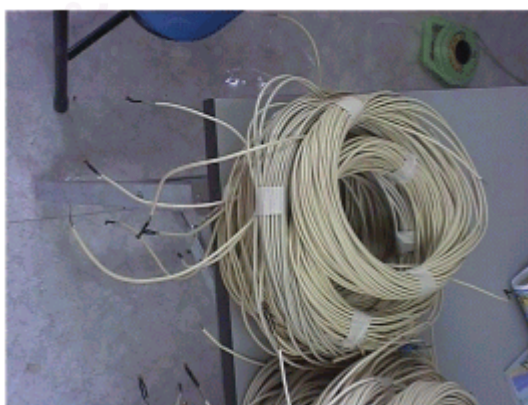
ภาพที่ 3.7 แสดงการต่อหัวเซนเซอร์เข้ากับสายโทรศัพท์ความยาว 25 เมตร เท่ากันทุกเส้น เพื่อใช้ในการบันทึกข้อมูลในครั้งนี้
