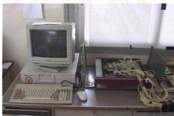
ภาพที่ 3.6 แสดงการต่อเครื่องคอมพิวเตอร์บันทึกข้อมูลร่วมกับเครื่องเก็บอุณหภูมิ System200
