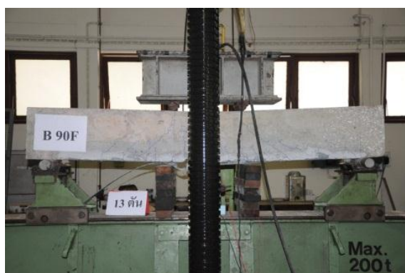
ภาพที่ 2.18 ตัวอย่างการวิบัติแบบแผ่นพอลิเมอร์เสริมเส้นใยหลุดล่อนของคานทดสอบภายหลังเผาไฟที่ระยะเวลา 90 นาทีแล้วซ่อมแซมด้วยแผ่นพอลิเมอร์เสริมเส้นใย[3]
