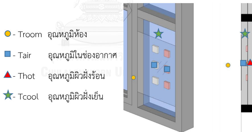
ภาพที่ 3.7 แสดงตำแหน่งการติดตั้งหัววัดอุณหภูมิ Thermocouple Type K.
