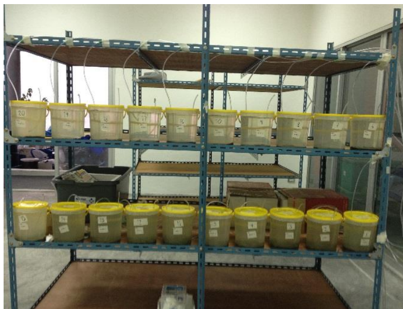
รูปที่ 3-1 ชุดการทดลองเพื่อศึกษาเบนทิกพลักซ์ของอนินทรีย์ไนโตรเจนในสถานะที่มีออกซิเจน และไม่มีออกซิเจนที่ความเค็มต่าง ๆ
