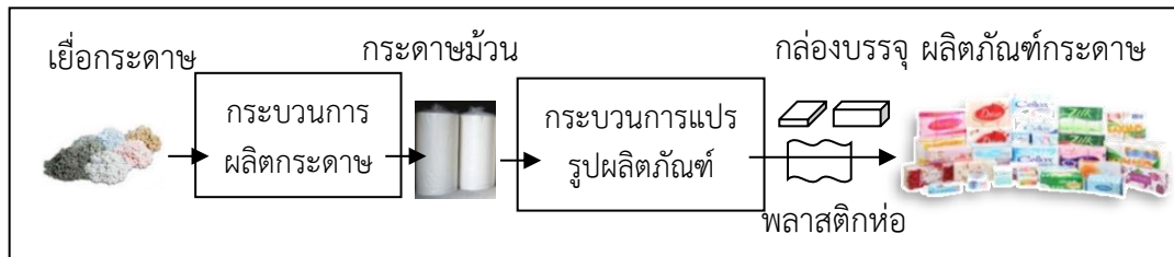
รูปที่ 1 ภาพจำลองกระบวนการผลิตและแปรรูปกระดาษทิชชู
