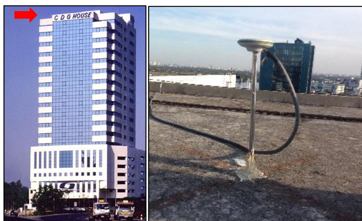
รูปที่ 3.5 สถานีฐานสำหรับการหาตำแหน่งแบบสถิต และเครื่องรับสัญญาณ Leica Viva GNSS GS10 Receiver
