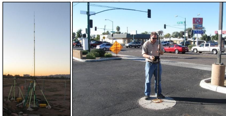
รูปที่ 2.25 การรังวัดแบบจลนในทันทีในภาคสนาม (ซ้าย: สถานีฐาน, ขวา: สถานีผู้ใช้งาน)
