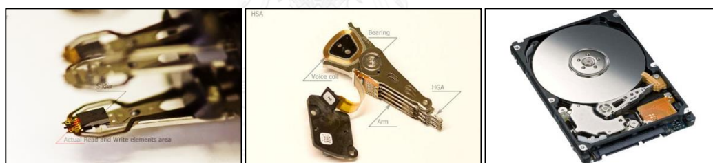
(ก) หัวอ่าน-เขียนข้อมูล (ข) ชุดหัวอ่าน-เขียนสำเร็จรูป (ค) ฮาร์ดดิสก์ไดรฟ์สำเร็จรูป
