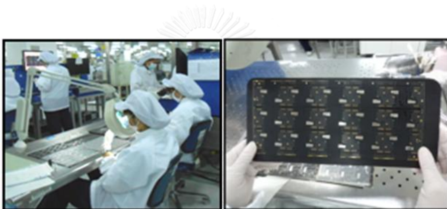
รูปที่ 4.6 การตรวจงานผ่านเลนส์ขยาย (ซ้าย) และตัวอย่างการตรวจงาน FPC Sheet (ขวา)
