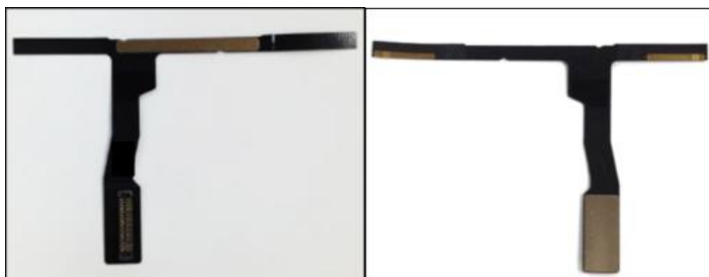
รูปที่ 1.2 ตัวอย่างผลิตภัณฑ์แผงวงจรไฟฟ้าแบบยืดหยุ่น
