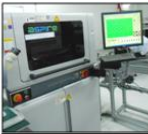
รูปที่ 4.7 เครื่อง Solder Past Inspection (SPI)
