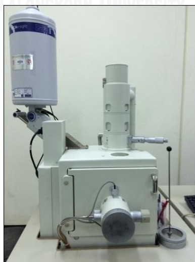
รูปที่ 3.6 กล้องจุลทรรศน์อิเล็กตรอนแบบส่องกราด ของ JEOL รุ่น JSM-6480LV
