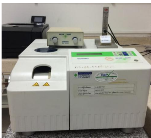
รูปที่ 3.7 เครื่องวิเคราะห์น้ำหนักภายใต้ความร้อน ของ Mettler Toledo รุ่น TGA/SDTA851
