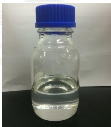
รูปที่ 3.1 เซลล์โพลีเมอร์ระดับจุลภาคแช่ในสารละลายผสมระหว่างลิเทียมคลอไรด์และ เอ็น เอ็น ได เมธิลอะเซตาไมด์เป็นระยะเวลา 7 วัน
