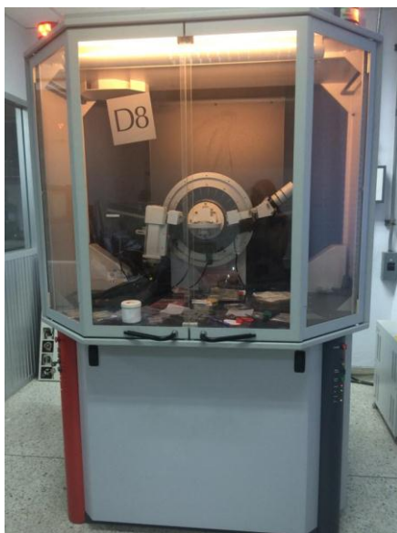
รูปที่ 3.5 เครื่องวิเคราะห์เลี้ยวเบนรังสีเอ็กซ์ ของ Bruker AXS รุ่น D8
