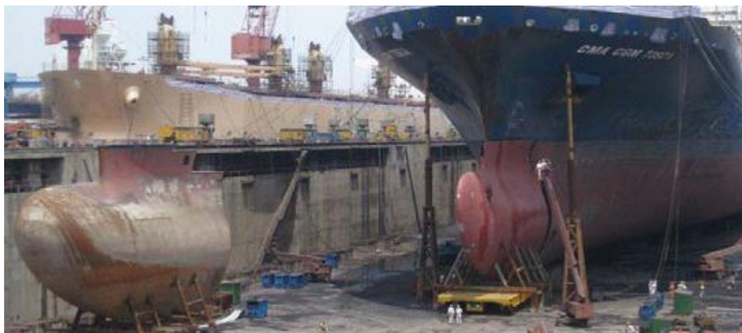
ภาพที่ 2.2 A new bulb adapted for low speed vessels
