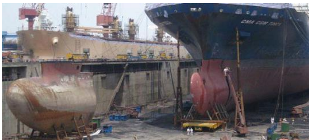
ภาพที่ 2 A new bulb adapted for low speed vessels
