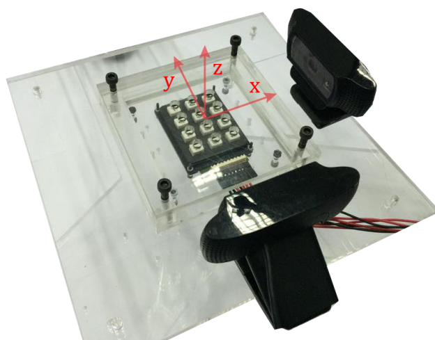
รูปที่ 4.14 การวางตำแหน่งของระบบกล้องดิจิทัล
