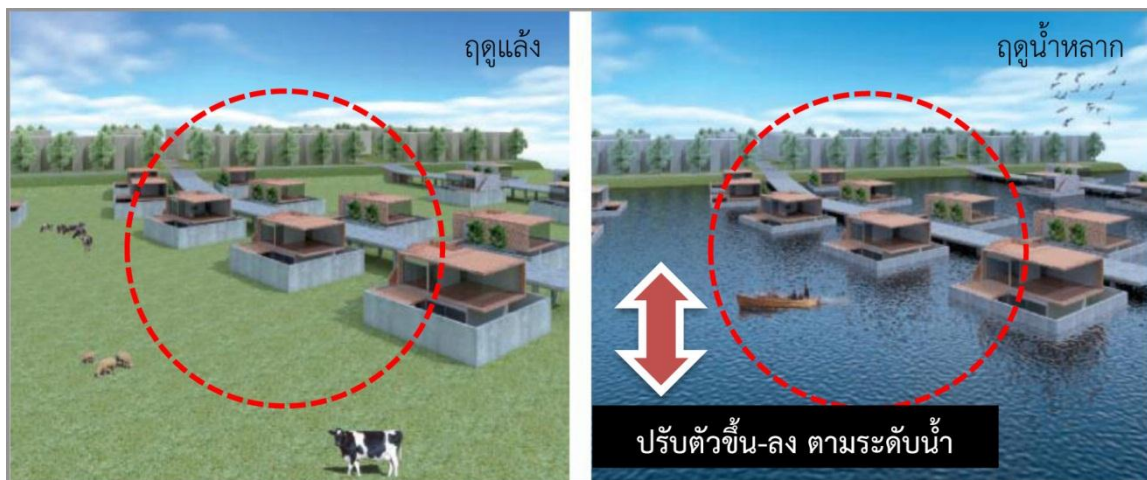
ภาพที่ 2-6 แสดงการออกแบบสถาปัตยกรรมเพื่ออยู่บนน้ำหรือลอยน้ำ
