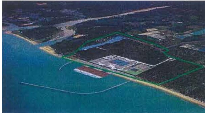
รูปภาพที่ 5 รูปแบบท่าเรือของโครงการที่ติดชายหาดและมีกำแพงกันคลื่น (ก่อนปรับปรุง) ที่มา: บริษัท เซฟรอนประเทศไทยสำรวจและผลิต จำกัด, 2555
