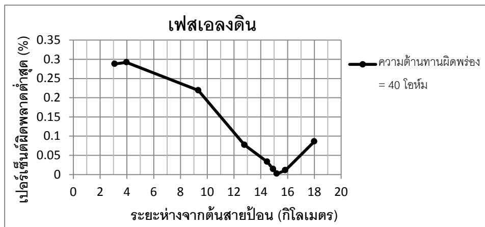
ภาพที่ 5.8 ผลการทดสอบความต้านทานผิวดำรง 40 โอห์ม
