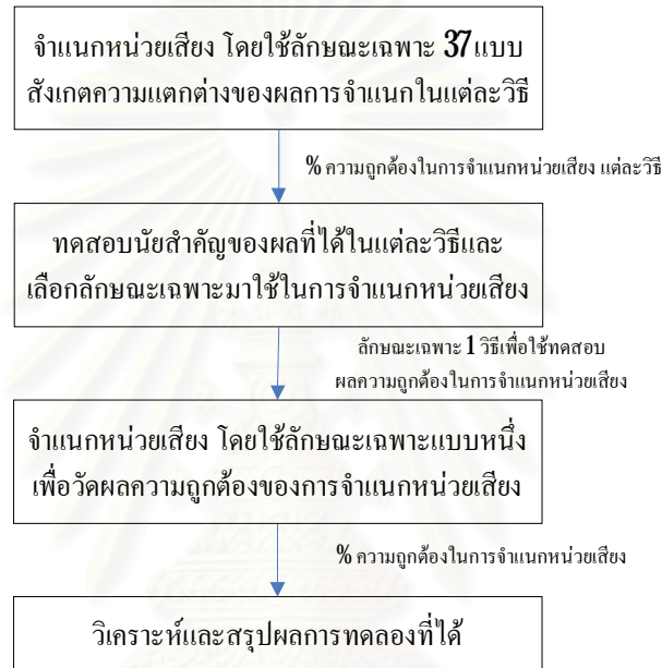
รูปที่ 5.1 ขั้นตอนการทดลองด้วยหลักการการวิเคราะห์ดิสคริมิแนนต์เชิงเส้น โดยใช้ลักษณะเฉพาะที่มีการทำงานแบบอาศัยเซกเมนต์
