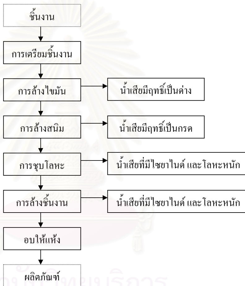
รูปที่ 2.2 ขั้นตอนการชุบโลหะด้วยไฟฟ้า
