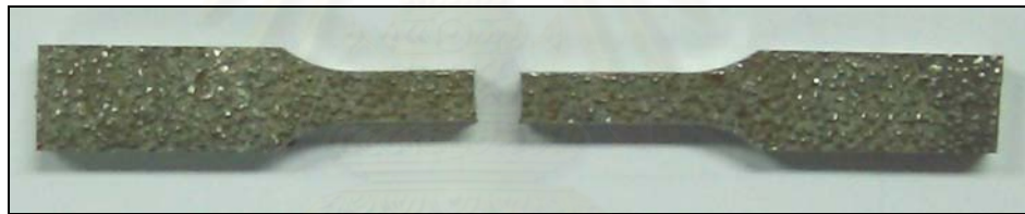
รูปที่ 4.27 ตัวอย่างหลังทดสอบแรงดึงของโลหะผสมเหล็ก นิกเกิล 30.8% โครเมียม 26.6% ในสภาพหล่อ ตามมาตรฐาน ASTM E 8M
