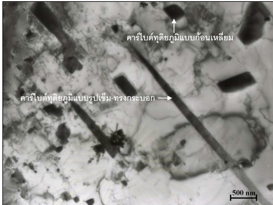
(ก) คาร์ไบด์ทุติยภูมิแบบก้อนเหลี่ยมและคาร์ไบด์ทุติยภูมิแบบรูปเข็ม-ทรงกระบอก ตกตะกอนในเนื้อพื้นออกสเตนไนต์
