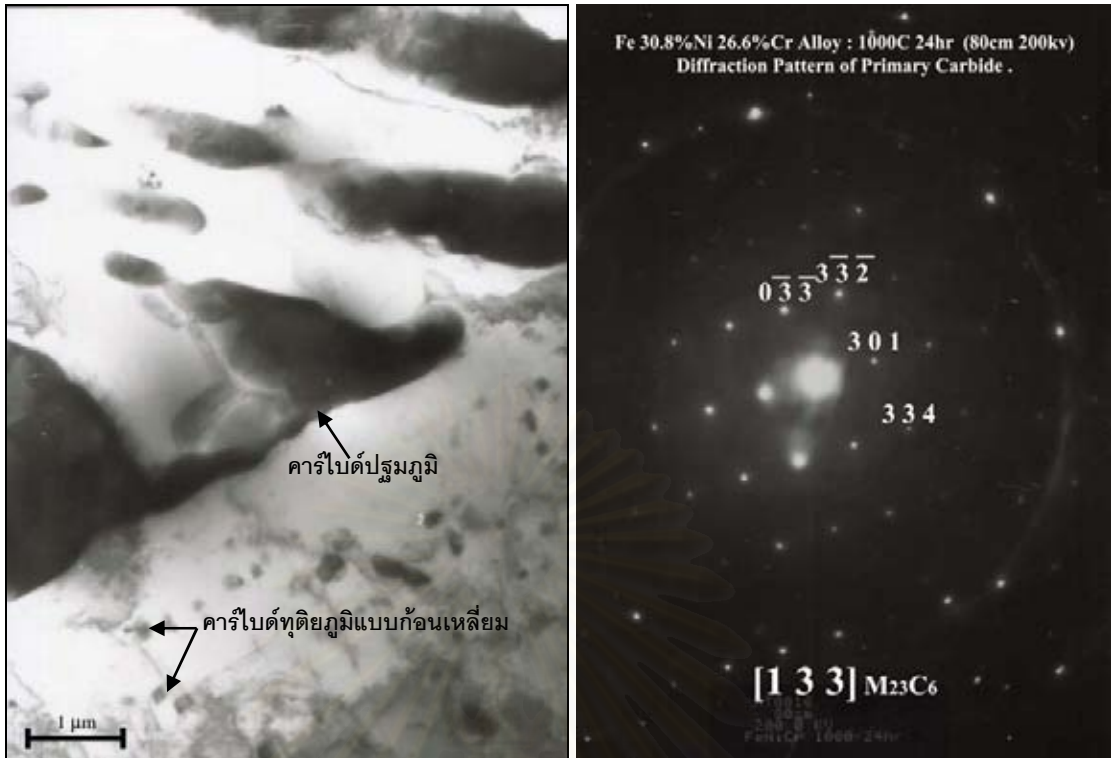
(ก) ตะกอนคาร์ไบด์ปฐมภูมิและคาร์ไบด์ทุติยภูมิแบบก้อนเหลี่ยมในเนื้อพื้น
