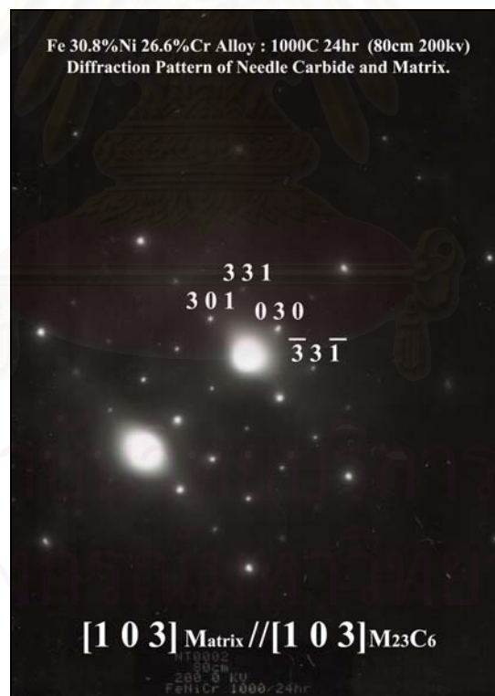
(ข) รูปแบบการเลี้ยวเบนของอิเล็กตรอนบริเวณคาร์ไบด์แบบรูปเข็มกับเนื้อพื้น
