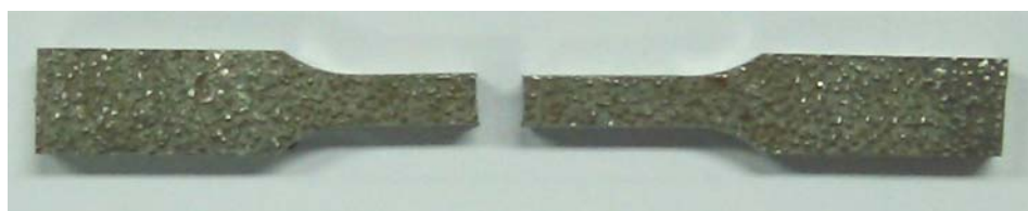
รูปที่ ซ.3 ชิ้นงานตัวอย่างหลังการทดสอบแรงดึง ตามมาตรฐาน ASTM E 8M
