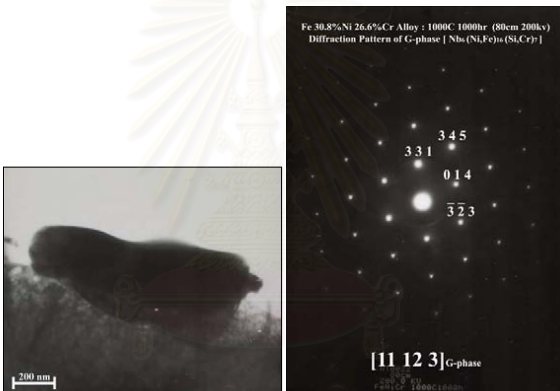
(ก) เฟส G ตกตะกอนในเนื้อพื้นออสเทนไนต์ (ข) รูปแบบการเลี้ยวเบนอิเล็กตรอนของเฟส G
