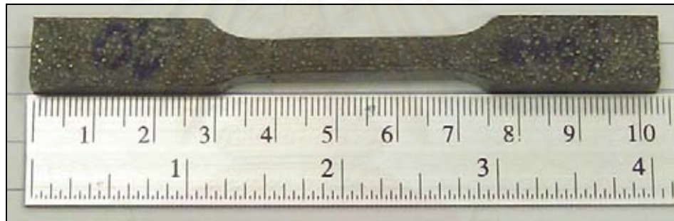
รูปที่ 3.2 ชิ้นงานตัวอย่างการทดสอบแรงดึงตามมาตรฐาน ASTM E 8M
