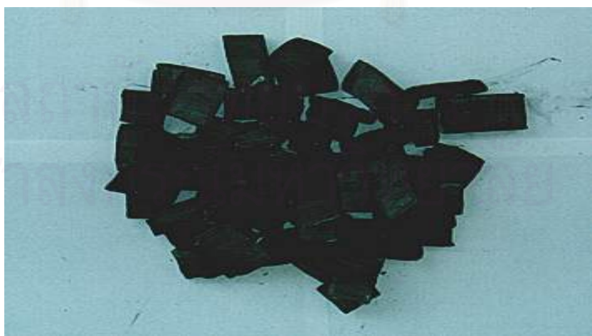
รูปที่ 4.1 ไม้ยูคาลิปตัสหลังการคาร์บอนไนซ์
