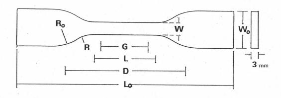
$W: 6 \text{ mm} \qquad W_{O}: 19 \text{ mm} \qquad G: 25 \text{ mm} \qquad R: 14 \text{ mm}$   $L: 33 \text{ mm} \qquad L_{O}: 115 \text{ mm} \qquad D: 65 \text{ mm} \qquad R_{O}: 25 \text{ mm}$
