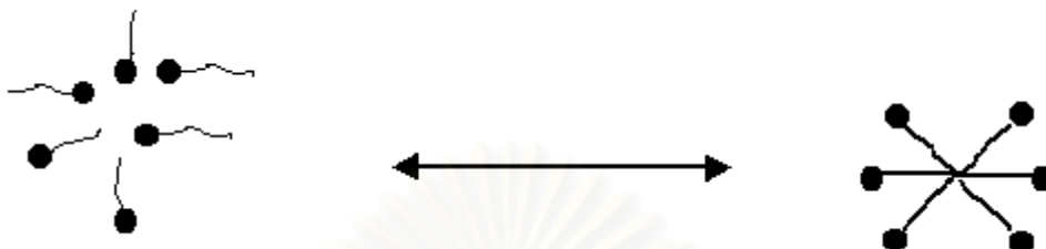
รูปที่ 2.6 โมเลกุลของสารลดแรงตึงผิวในการเกิดไมเซลล์
