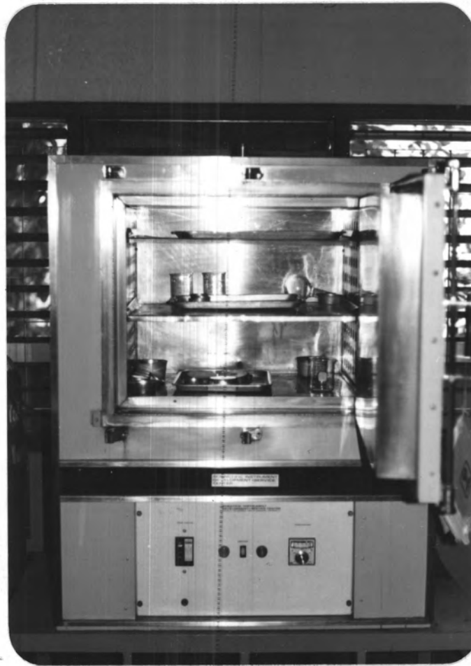
รูปที่ 3.1 ตู้ควบคุมอุณหภูมิตั้งแต่ 0-400 องศาเซลเซียส
