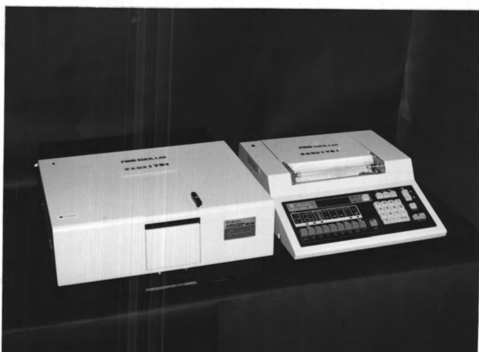
รูปที่ 3.8 เครื่อง Double Beam Spectrophotometer รุ่น UV 240 ของบริษัท Shimadzu ประเทศญี่ปุ่น สามารถปรับความยาวคลื่น ได้ 190-900 นาโนเมตร
