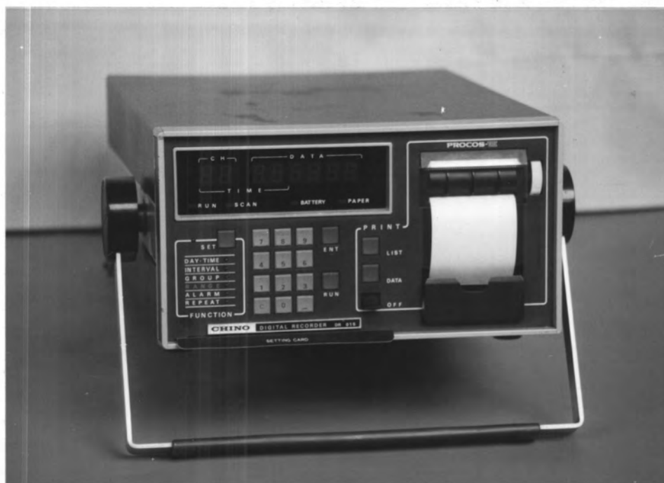
รูปที่ 3.3 เครื่องบันทึกอุณหภูมิของบริษัท Chino แบบ Digital recorder process-VII รุ่น DR 015 ความละเอียด 0.3 องศาเซลเซียส
