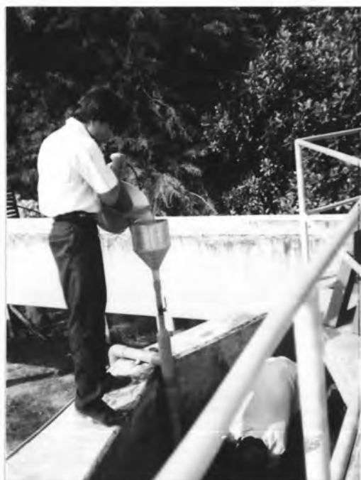
5. กรอกน้ำเสียผ่านกรวยกรองเข้าระบบจนเต็มท่อผ่านน้ำ
