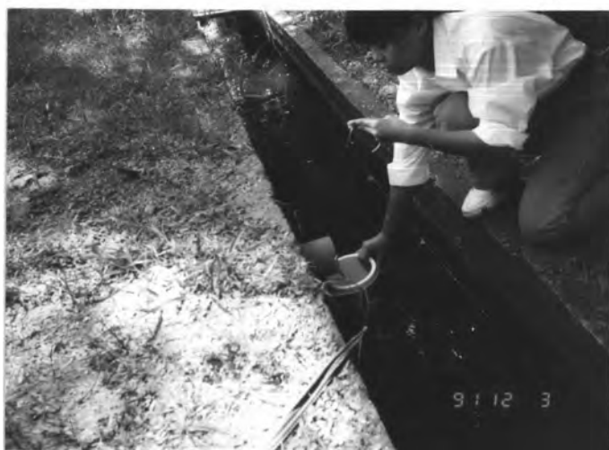
7. เก็บตัวอย่าง EFFLUENT และตรวจเช็คอัตราการไหล
