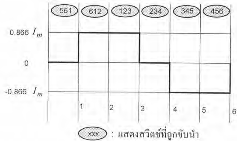
รูปที่ 3.17 รูปคลื่นกระแสที่โหลด เมื่อ \phi = 120^\circ
