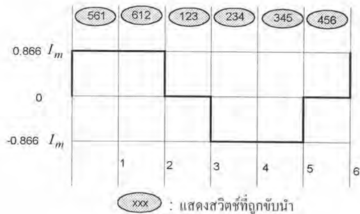
รูปที่ 3.15 รูปคลื่นกระแสที่โหลด เมื่อ \phi = 60^\circ
