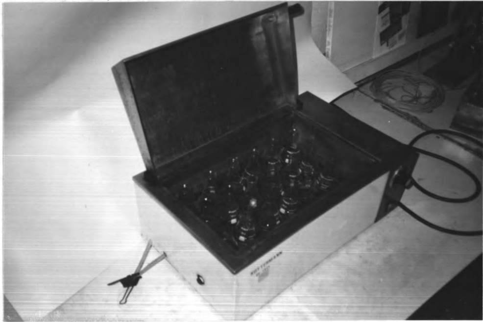
ภาพที่ 3.1 แสดงอุปกรณ์เครื่องมือการสกัดแบบแช่ครั้งเดียวไม่มีการกวน
