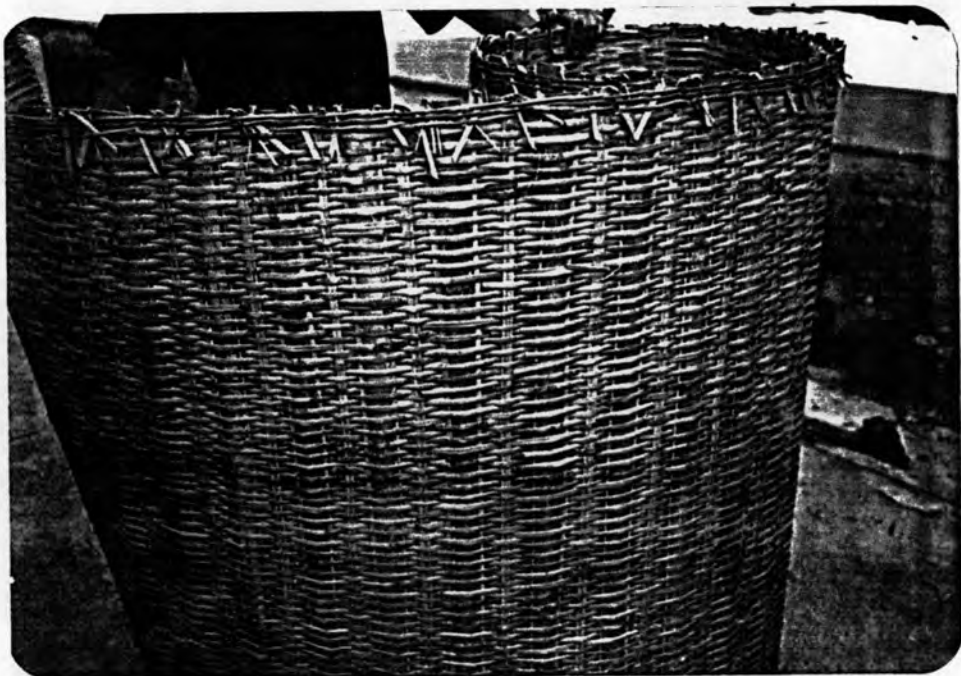
รูปที่ 4.12 แสดงเสวียนทำจากพืชมั้รวกเพื่อใช้บุผนังด้านในไซโล
