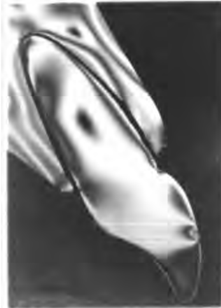
รูปที่ ๓๑ รูปแบบของความเค้นภายในแบบจำลองฟันซึ่งได้รับแรงกระทำในบริเวณต่างๆ วิเคราะห์โดยวิธีไฟโตอีลาสติก (Caputo และ Standlee, 1987)
