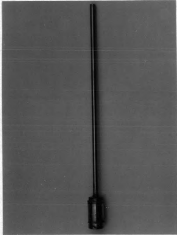
ภาพที่ 3.3 เครื่องปฏิกรณ์สำหรับไพโรไลซ์ (pyrolyzed reactor)
