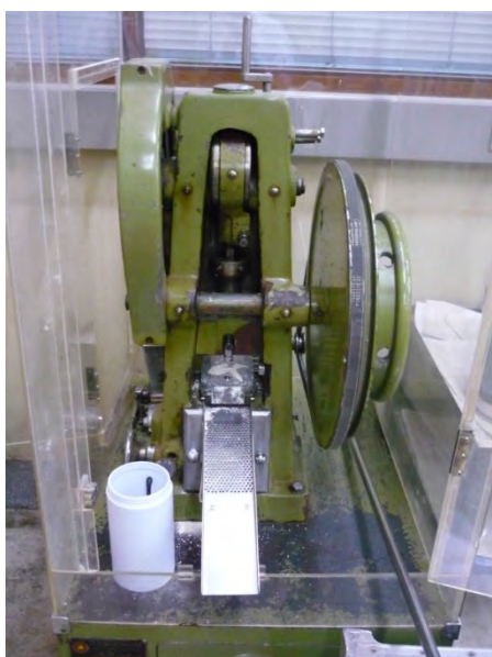
รูปที่ 17 แสดง Single punch tablet press
