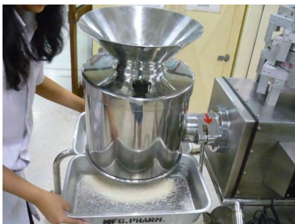
รูปที่ 15 แสดงการย่อยขนาดเม็ด slug ด้วยเครื่อง high speed granulator
