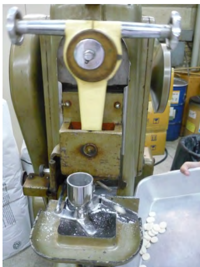
รูปที่ 13 แสดง Slugging tablet press
