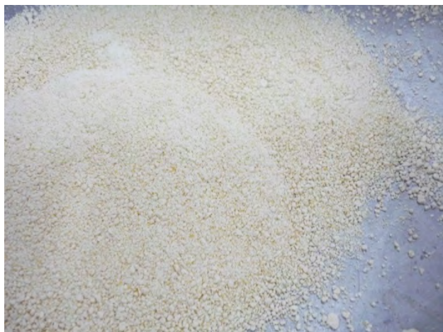
รูปที่ 16 แสดงลักษณะของ granule ที่ได้จากการย่อยขนาดเม็ด slug
