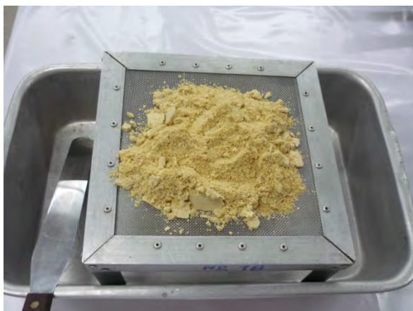
รูปที่ 11 แสดงการร่อนผงถั่วเหลืองด้วยร่อนเบอร์ 18
