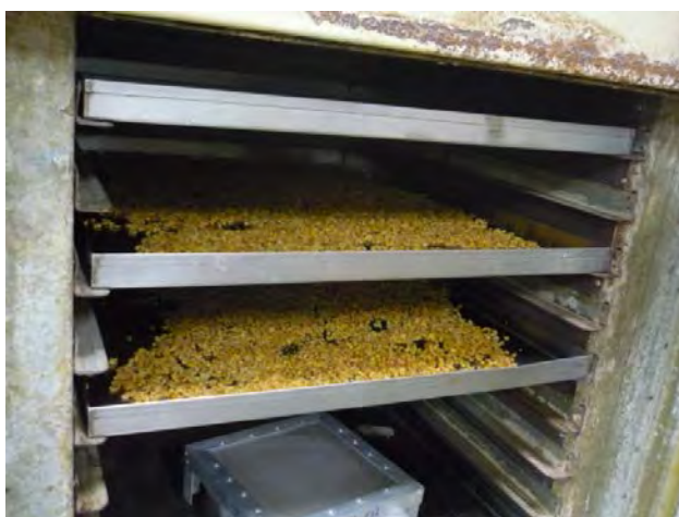
รูปที่ 8 แสดงการอบเมล็ดถั่วเหลืองด้วย hot air oven
