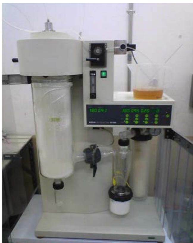
รูปที่ 3.1 เครื่อง BÜCHI Mini Spray Dryer B-290
