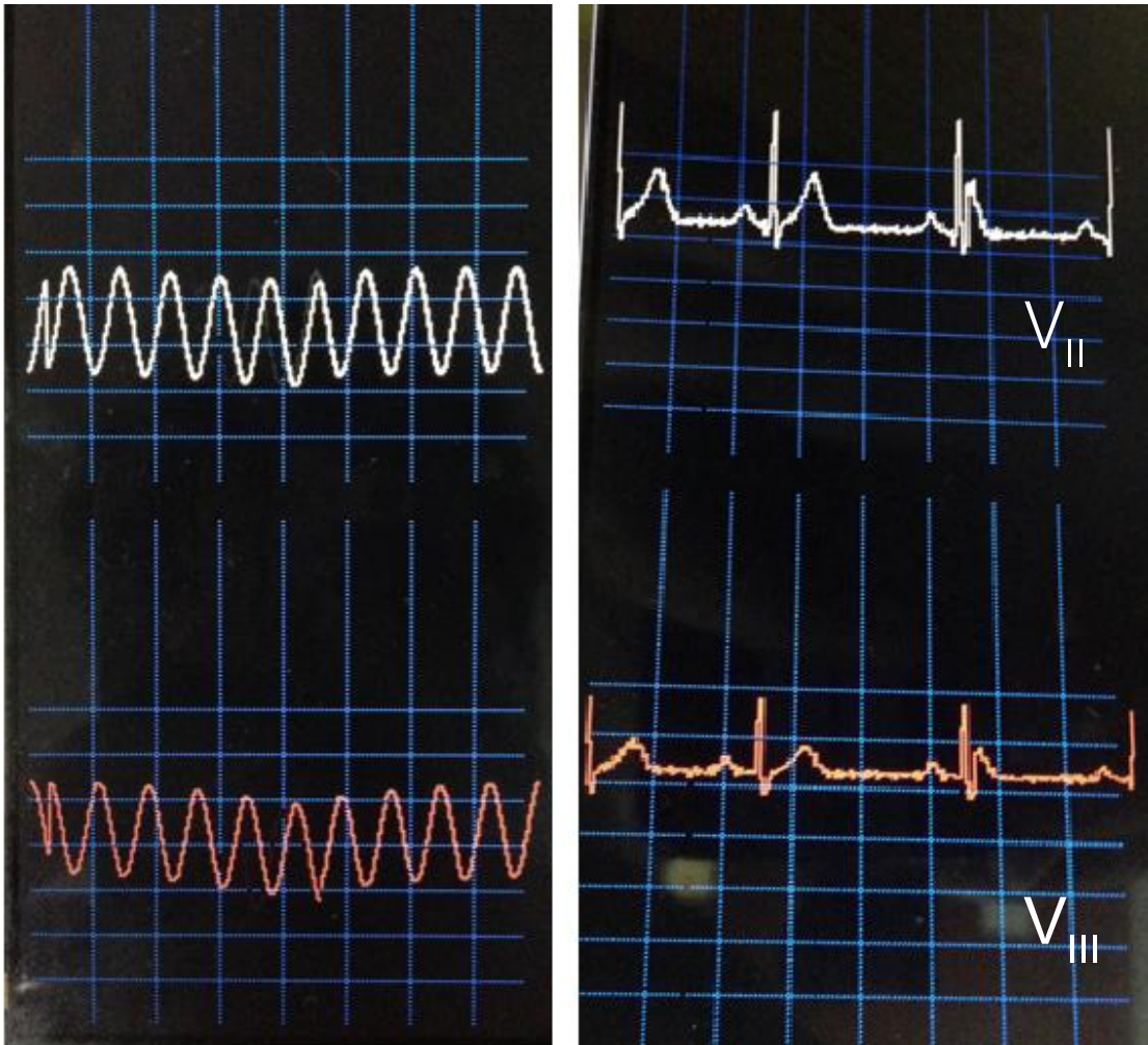
รูปที่ 4.18 กราฟแสดงสัญญาณไซน์และคลื่นไฟฟ้าหัวใจที่แสดงผลผ่านทางหน้าจอแอลซีดี
