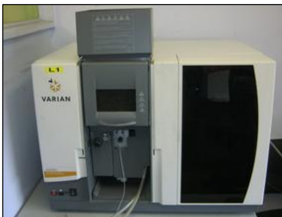
ภาพที่ 3.4 เครื่อง Atomic Absorption Spectrophotometry (AAS) ยี่ห้อ Varian รุ่น AA 280 FS
