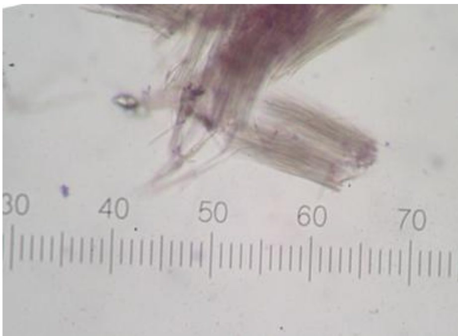
รูปที่ 4.3 ภาพถ่ายจากกล้องจุลทรรศน์แสดงผลึกลักษณะใยรูปเข็ม (กำลังขยาย 400 เท่า)
