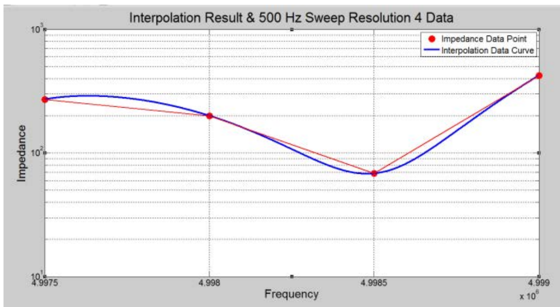
รูปที่ 4-4 การทำการประมาณค่าในช่วงเพื่อหาความถี่ก้ำอรรถด้วยการกวาดความถี่ขึ้นละ 500 Hz
