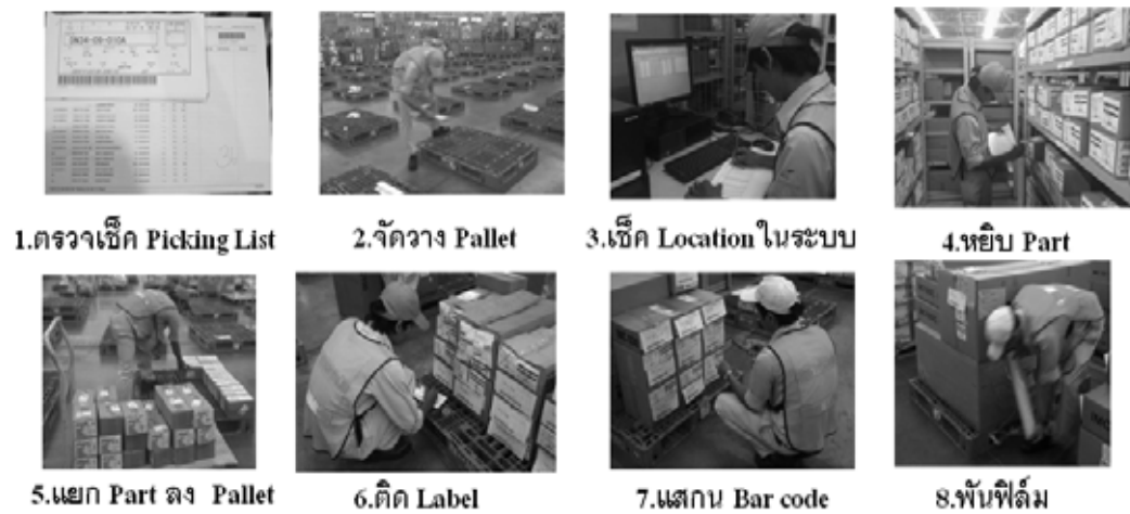
ภาพที่ 3.9 ขั้นตอนการหยิบชิ้นส่วนยานยนต์ประเภทกล่องขนาดเล็ก
