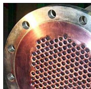
รูปที่ 3.3 เครื่องแลกเปลี่ยนความร้อนแบบเชลล์และท่อที่ใช้ในกระบวนการผลิตโพลีโพรพิลีน
