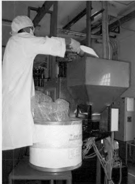
รูปที่ 5.8 พนักงานคัดเกรซินใส่ถังเก็บเรซิน
