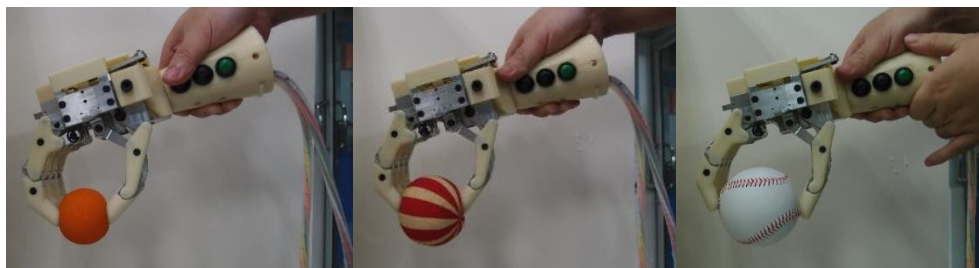
รูปที่ 5.26 การทดสอบจับวัตถุทรงกลมด้วยท่าจับแบบแมนยำ
