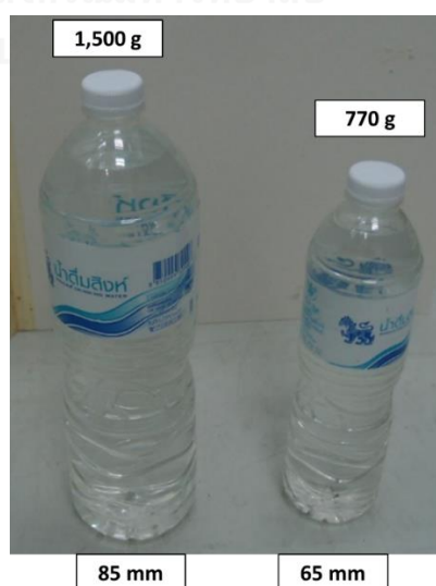
รูปที่ 5.21 วัตถุทรงกระบอกประเภทขวดน้ำสำหรับการทดสอบ เส้นผ่านศูนย์กลาง 65 และ 85 มิลลิเมตร มีน้ำหนัก 770 กรัมและ 1,500 กรัม
