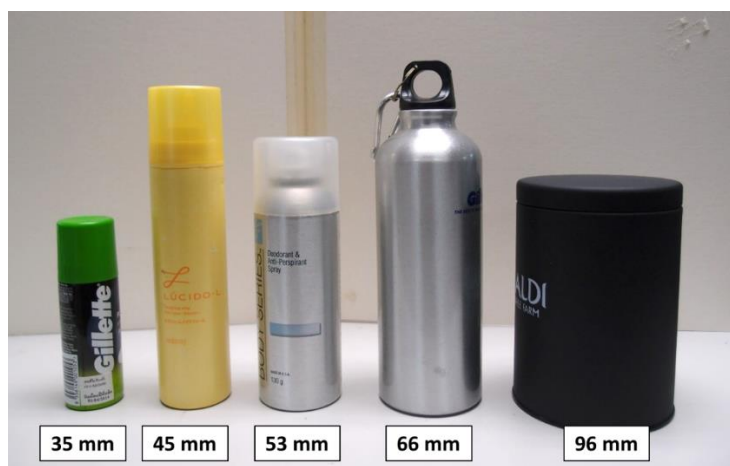
รูปที่ 5.19 วัตถุทรงกระบอกสำหรับทดสอบ เส้นผ่านศูนย์กลาง 35, 45, 53, 66 และ 96 มิลลิเมตร
