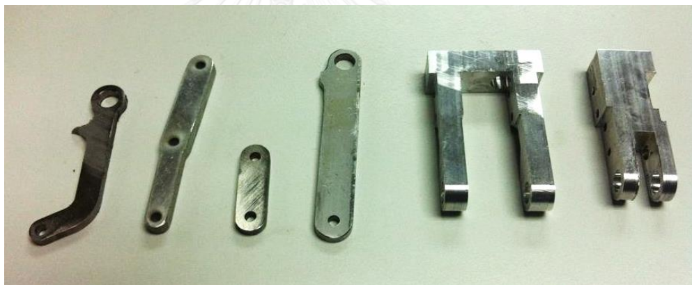
รูปที่ 4.43 ชิ้นส่วนกลไกขั้วมือเทียม ผลิตด้วยการกัด (Milling) เป็นหลัก
