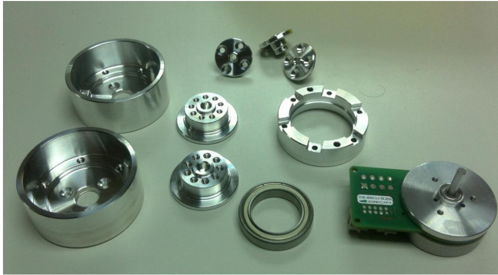
รูปที่ 4.37 ชิ้นส่วนห้องเกียร์ทดที่ถูกผลิตขึ้น
