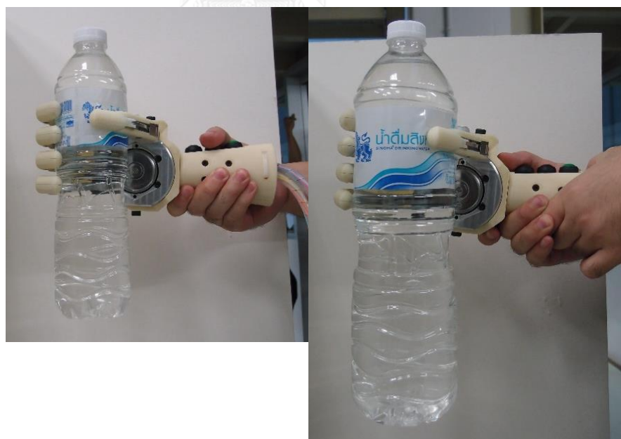
รูปที่ 5.28 การทดสอบจับยกวัตถุขวดน้ำทรงกระบอก (น้ำหนัก 770 และ 1500 กรัมจากด้านซ้าย) ด้วยท่าจับแบบกำมือ
