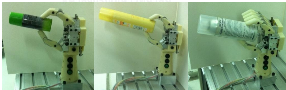
รูปที่ 5.23 การทดสอบจับวัตถุทรงกระบอกในท่าจับแบบแม่นยำ
