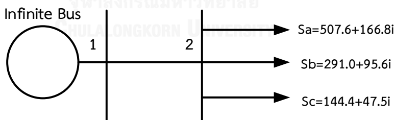
ภาพที่ 6.16 ระบบทดสอบ 2 บัส แบบโหลดไม่สมดุล
