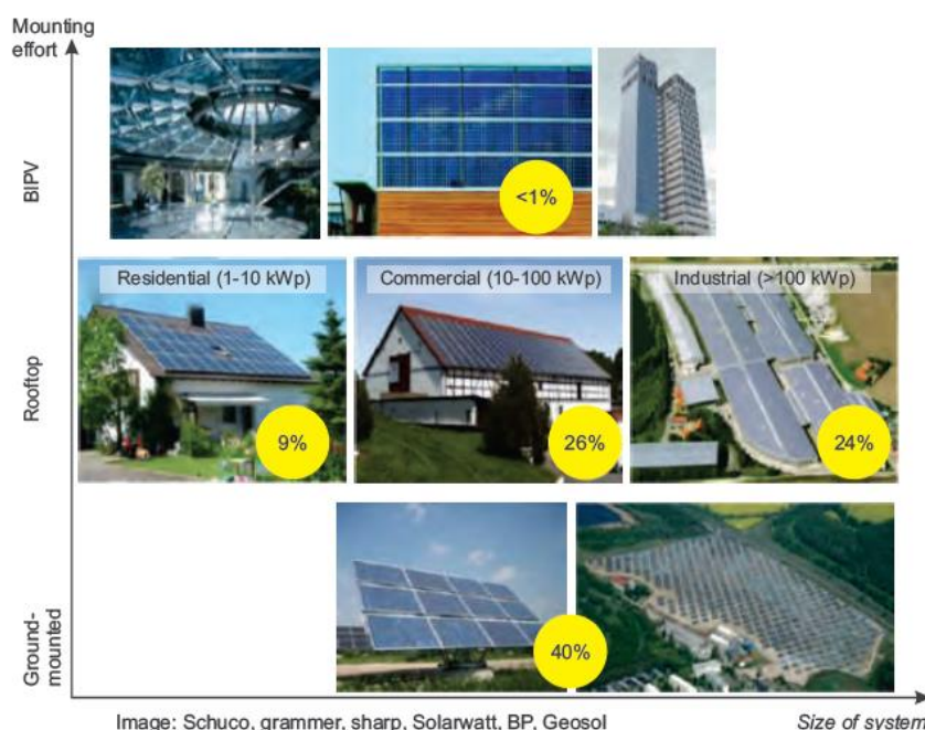
ภาพที่ 2.9 สัดส่วนในการติดตั้งระบบผลิตไฟฟ้าจากเซลล์แสงอาทิตย์ของประเทศเยอรมนี
