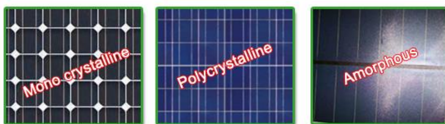
ภาพที่ 2.1 เซลล์แสงอาทิตย์ที่ทำจากสารกึ่งตัวนำซิลิกอน
